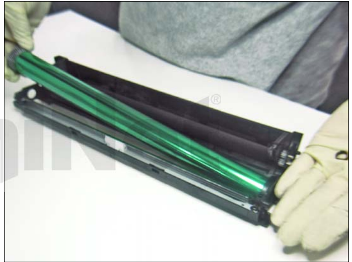
17. Remove the OPC drum.
